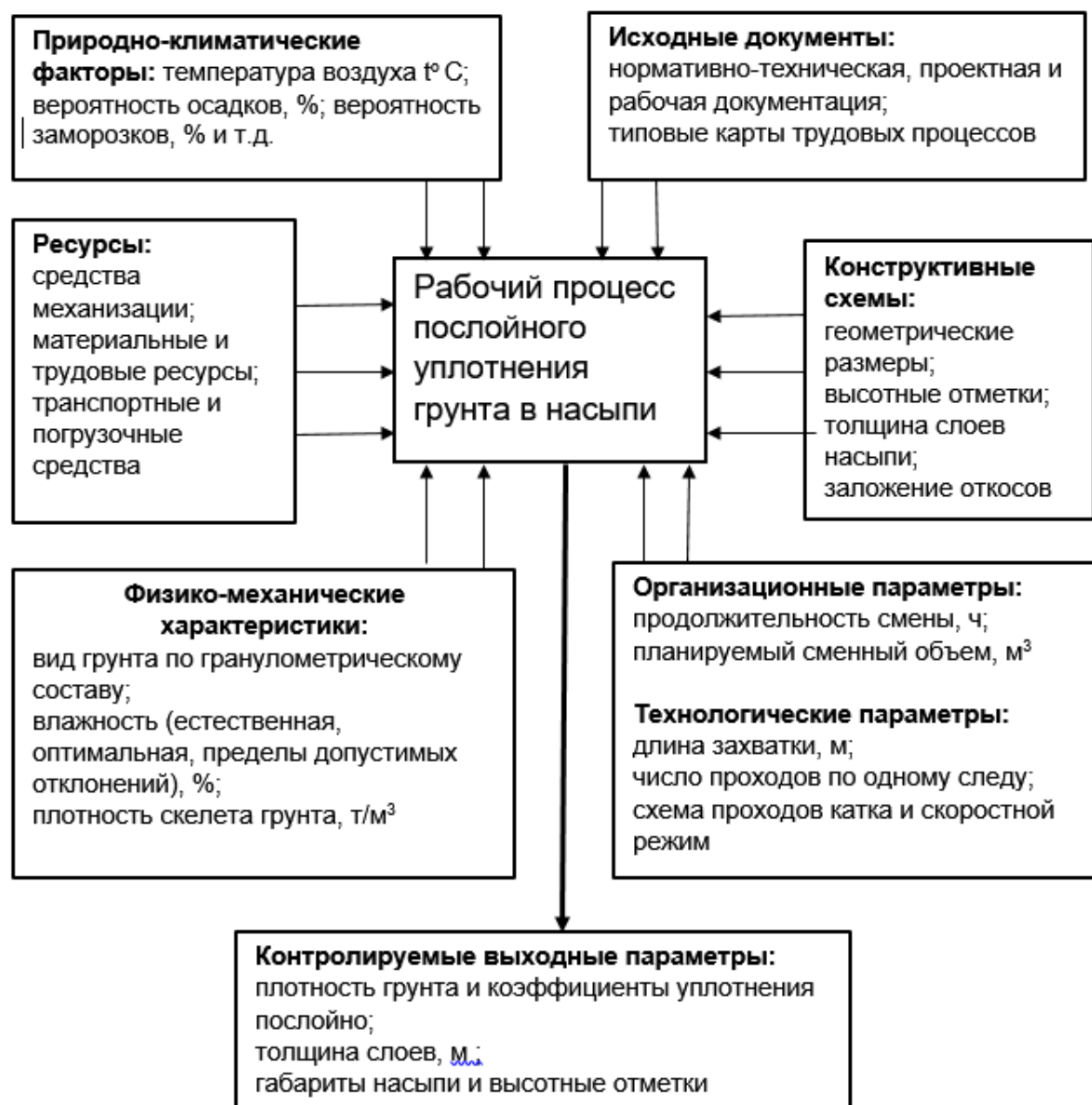
Рисунок 2 – Структурно-модульная схема рабочего процесса послойного уплотнения грунта в насыпи автомобильной дороги Источник: составлено авторами.
