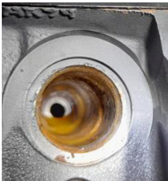
Рисунок 2 – Фотографии дефектных головок блока цилиндров двигателей КамАЗ-740.7 а – следы антифриза в форсуночном колодце; б – опрессовка головки блока цилиндров Источник: составлено авторами.
