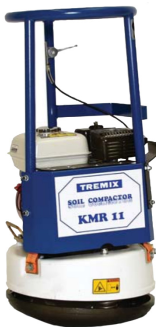
Рисунок 3 – Неревверсивная виброплита Tremix KMR 11 с круглым основанием 4
