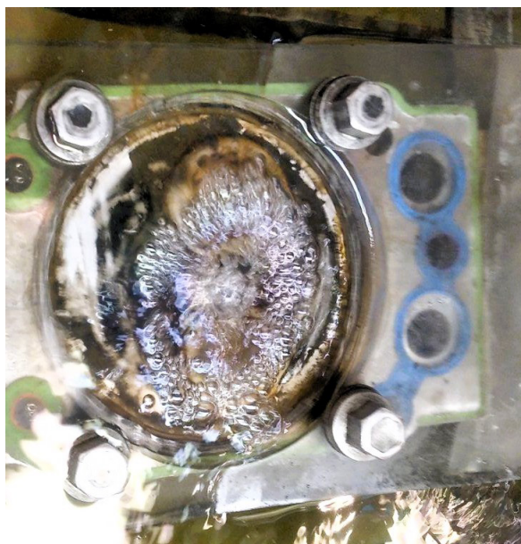
Рисунок 2 – Фотографии дефектных головок блока цилиндров двигателей КамАЗ-740.7 а – следы антифриза в форсуночном колодце; б – опрессовка головки блока цилиндров Источник: составлено авторами.
