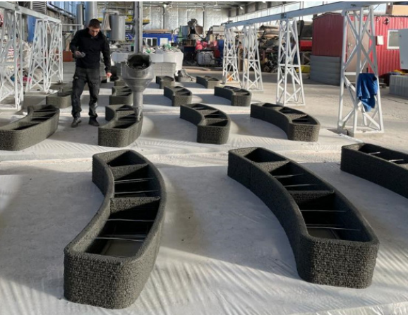
Рисунок 6 – Результат печати основания МАФ разработанной составом 4а Источник: Бетоник-Арт (г. Белгород).
