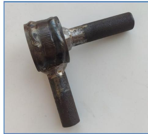
Рисунок 5 – Трехмерная модель проточной части вихревого гидродиода (а) и изготовленный экспериментальный образец гидродиода (б):
