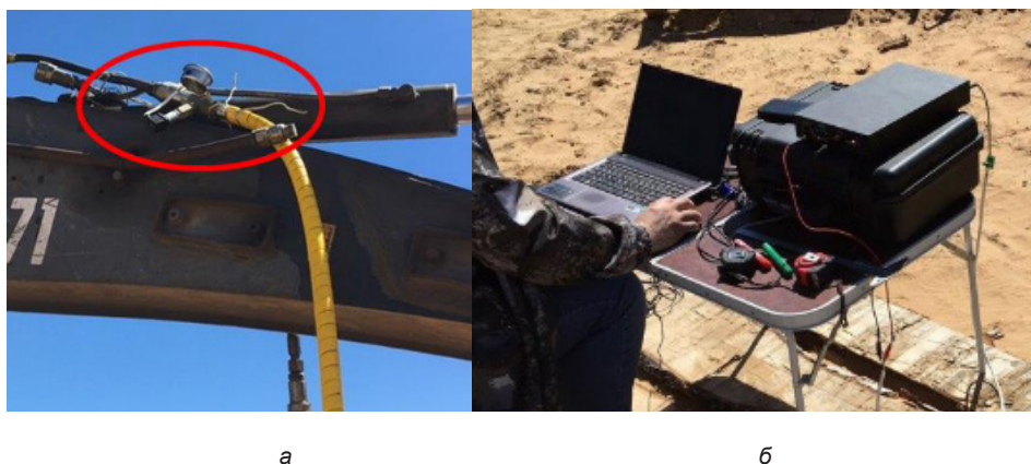
Рисунок 2 – Оборудование для регистрации давления в гидроцилиндре: а – датчик давления; б – измерительная система
