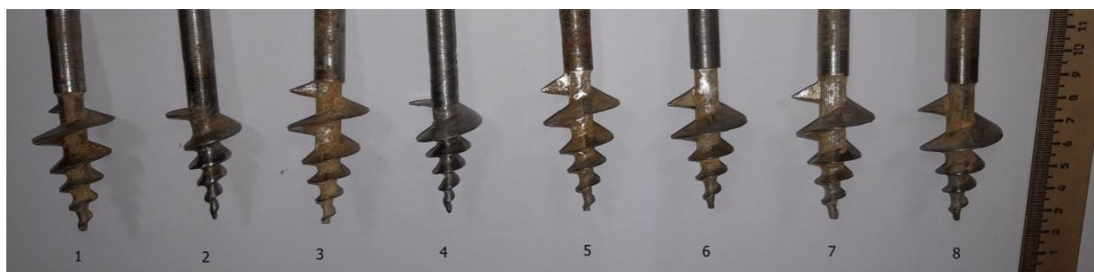
*Рисунок 2 – Исследуемые модели буровых инструментов:*
