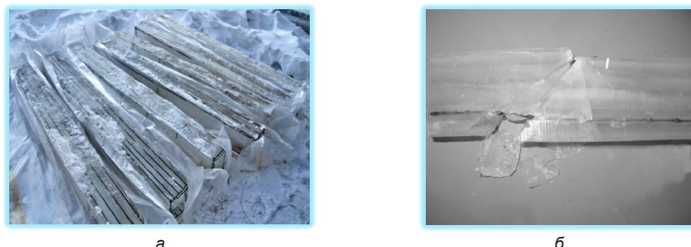
*Рисунок 8 – Особенности разрушения армированного льда:*
