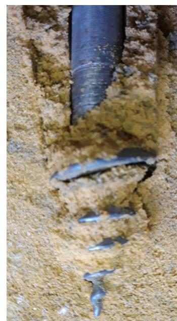
Рисунок 3 – Процесс разрушения грунта буровым инструментом
