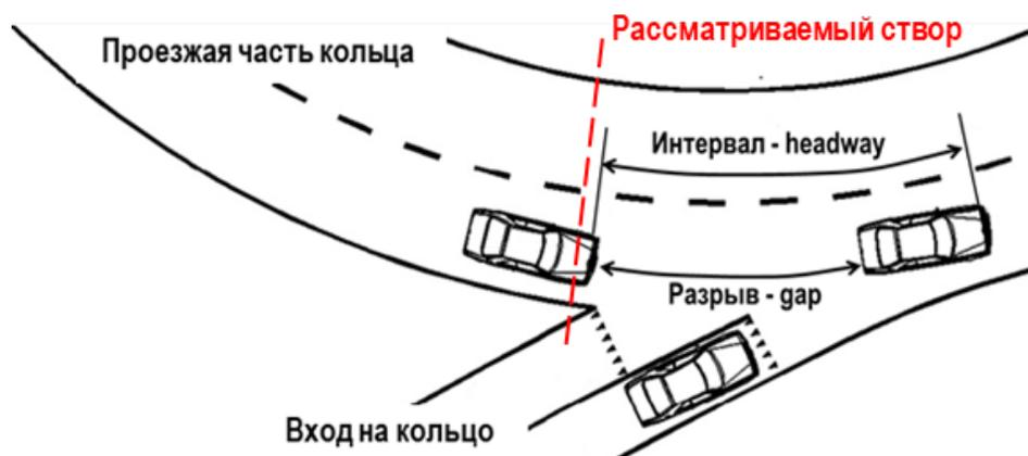
Рисунок 3 – Определение интервалов в потоке на кольцевой проезжей части
