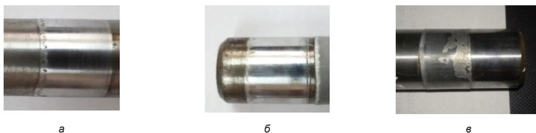
Рисунок 2 – Вид испытуемого образца-вала в зависимости от нагрузки: а – при нагрузке 0 МПа; б – при нагрузке до 270 МПа; в – при нагрузке 300 МПа<sup>9</sup> [19, 20, 21]
