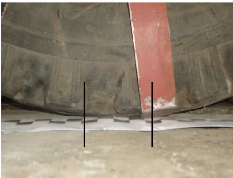
Рисунок 3 – Размер пятна контакта экспериментального рабочего органа (12 бандажей)
