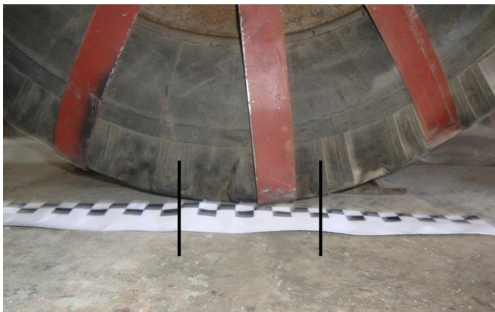
Рисунок 2 – Размер пятна контакта экспериментального рабочего органа (8 бандажей)
