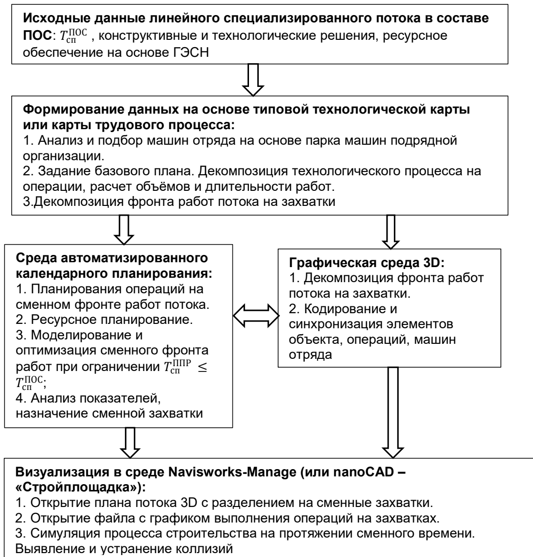
Рисунок 1 – Блок-схема моделирования специализированного линейного потока в компьютерной среде Источник: составлено автором
