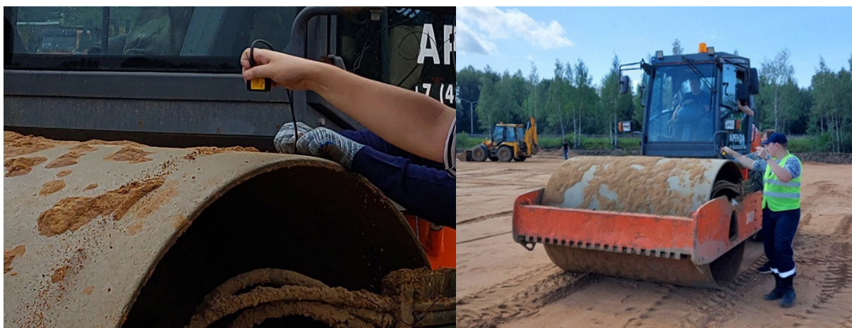
Рисунок 2 – Измерения вертикальных перемещений вальца катка HAMM 3411 лазерным датчиком BAUMEROADM 13U6480/S35A Источник: составлено авторами.
