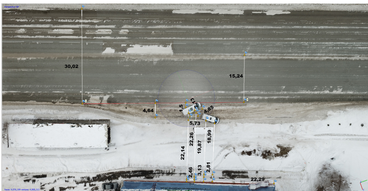
Рисунок 2 – Цифровая модель участка дорожно-транспортного происшествия Источник: составлено автором.
