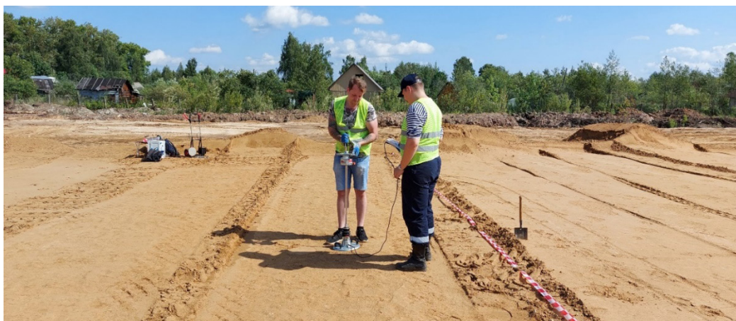
Рисунок 3 – Измерение модуля динамического нагружения грунта установкой ZORN ZFG3.0 Источник: составлено авторами.
