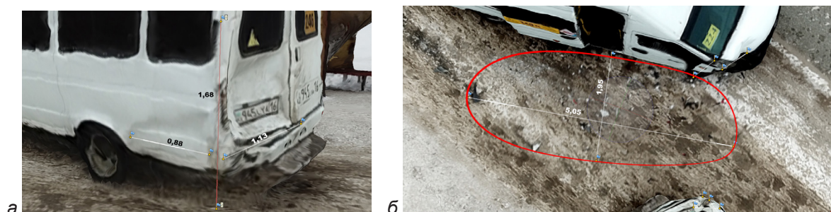
Рисунок 3 – Определение необходимых параметров по цифровой модели: а – локализация повреждений транспортного средства; б – определение области россыпи осколков Источник: составлено автором.
