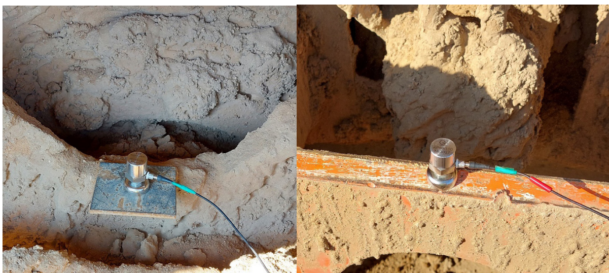
Рисунок 1 – Расположение акселерометров: на вальце катка (левый рисунок) и на раме вальца (правый рисунок) Источник: составлено авторами.
