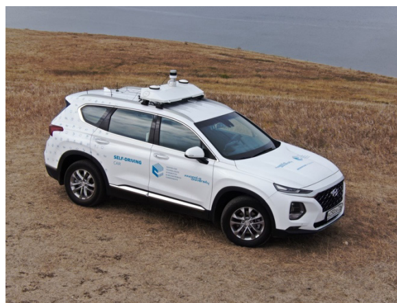
Рисунок 12 – Беспилотный автомобиль Hyundai Santa FE с набором сенсоров для проведения испытаний Источник: составлено авторами.
