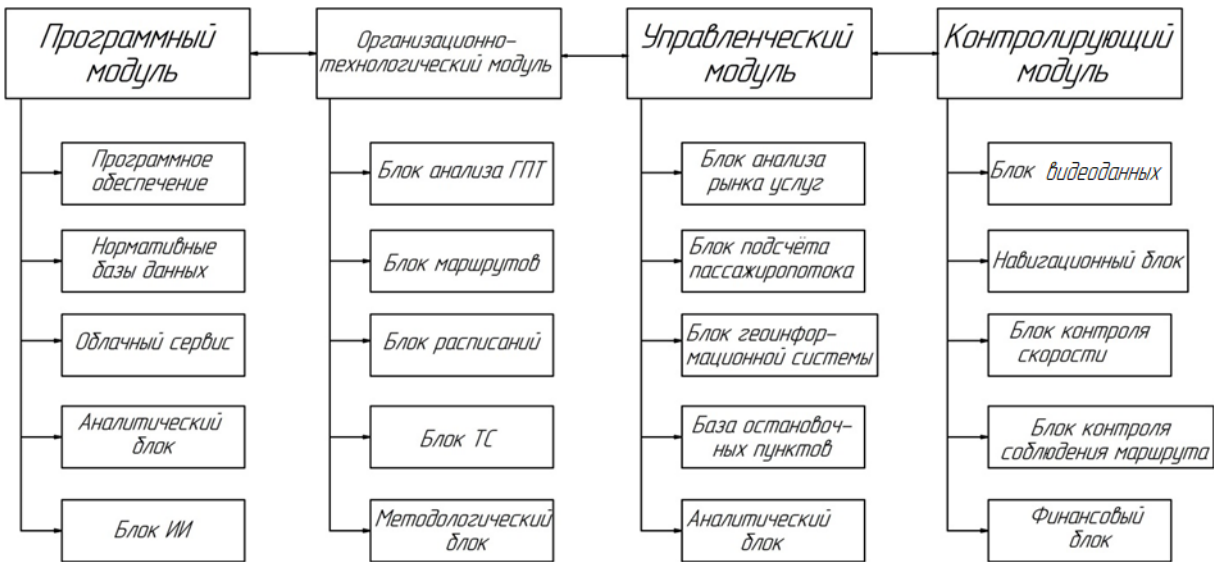
Рисунок 5 – Структура интеллектуальной системы управления пассажирскими автомобильными перевозками Источник: составлено авторами.
