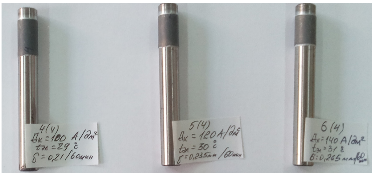
Рисунок 1 – Образцы для исследования прочности сцепления на различных режимах Источник: составлено автором.
