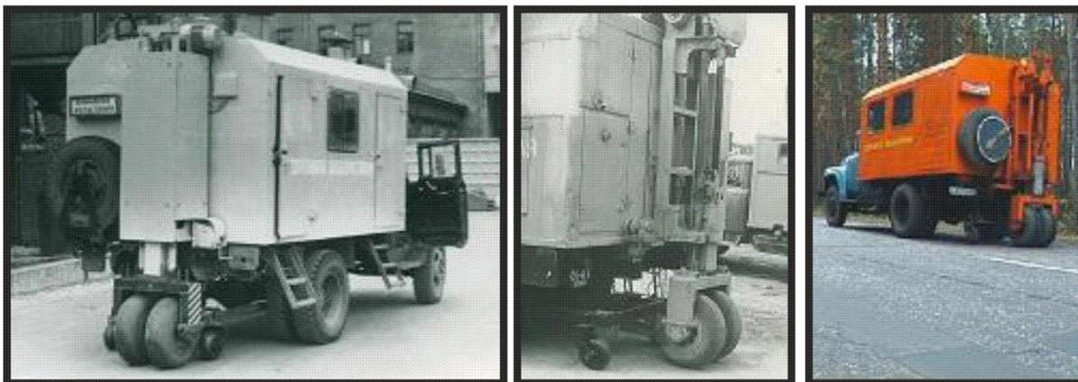
Рисунок 3 – Установка динамического нагружения нагрузка колесная
