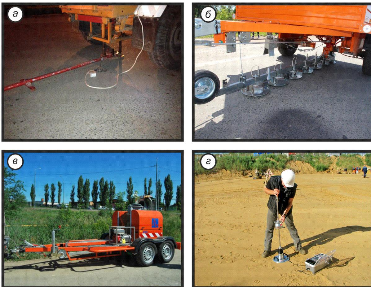
Рисунок 1 – Установки динамического нагружения для штамповых испытаний:
