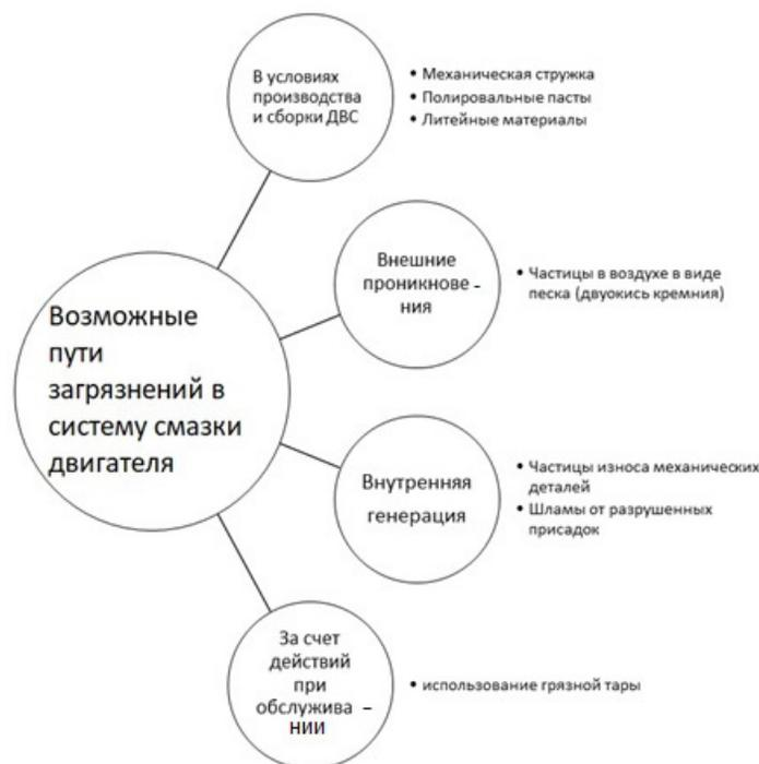
Рисунок 2 – Пути попадания твёрдых загрязнителей в моторное масло
