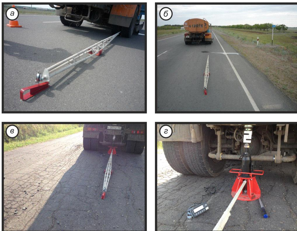
Рисунок 2 – Испытания дорожных одежд статической нагрузкой:
