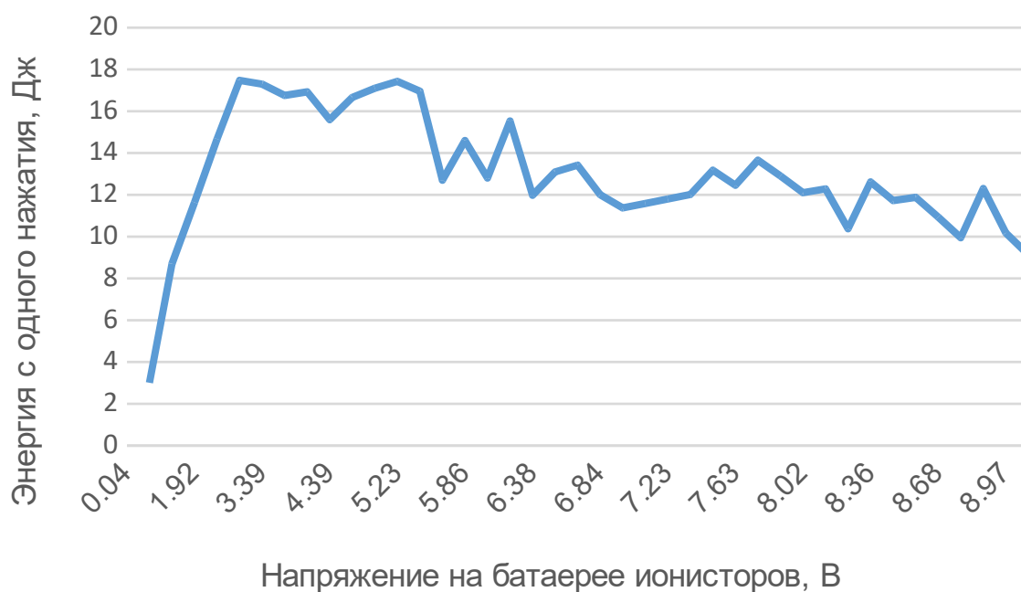
Рисунок 4 – Энергия, получаемая с одного нажатия при различном уровне заряда на батарее ионисторов
