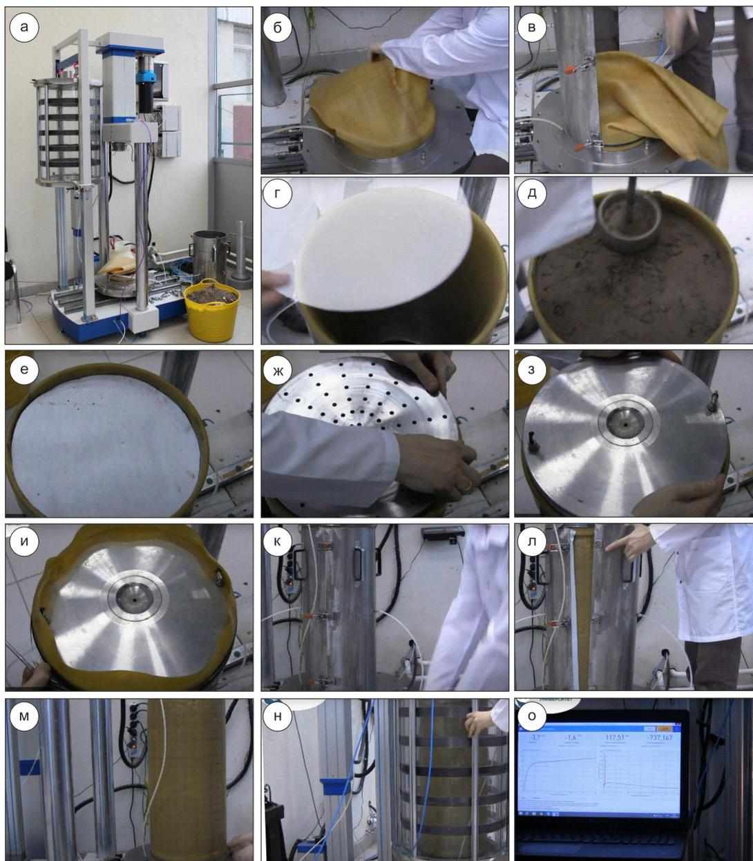
Рисунок 1 – Трехосные испытания крупнообломочного грунта в лаборатории МГСУ при помощи прибора конструкции НПО «Геотек»:
