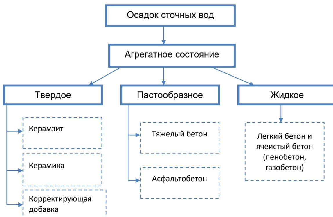
Рисунок 1 – Классификация утилизации осадков в производстве строительных материалов
