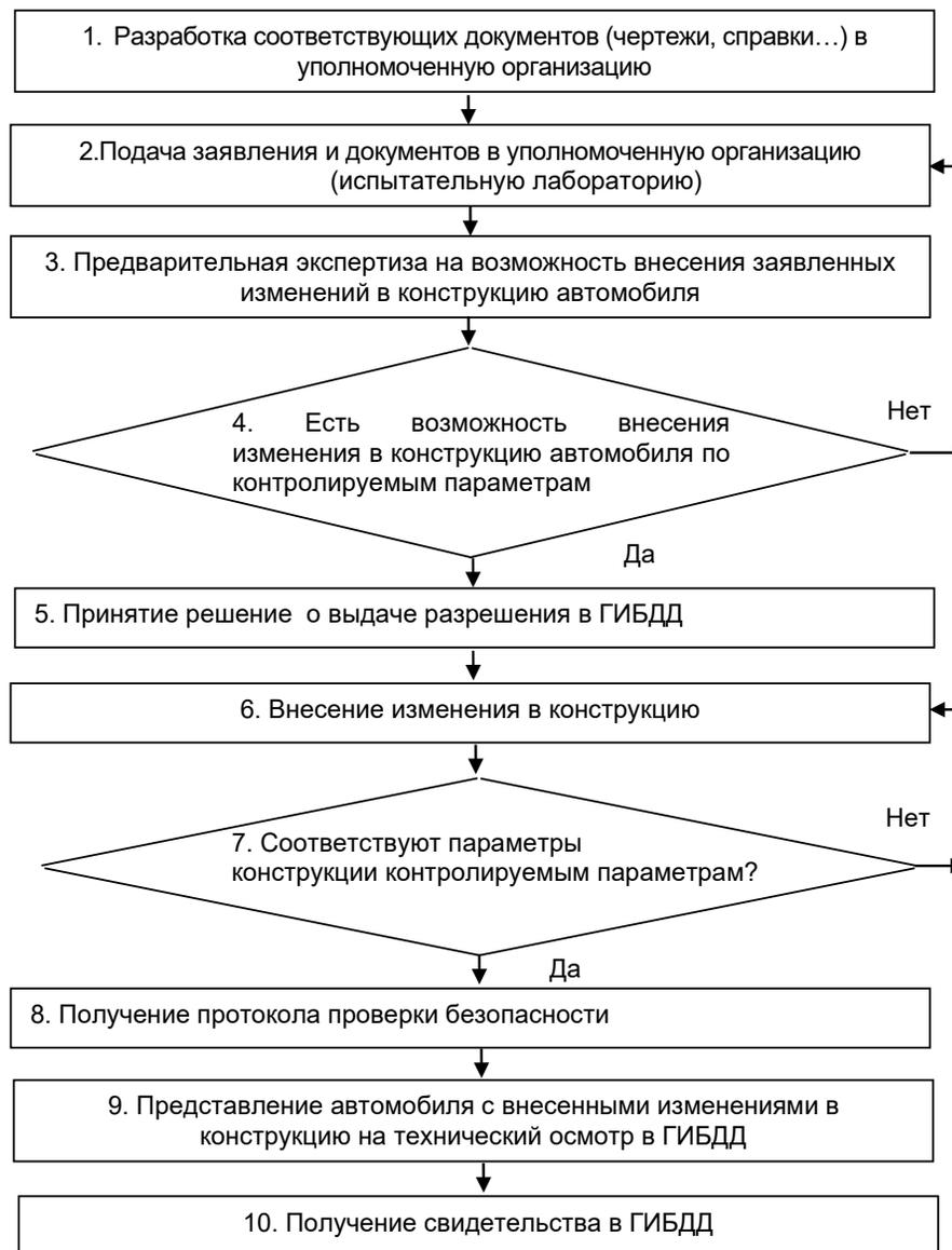
Рисунок 1 – Алгоритм методики для получения свидетельства в ГИБДД после внесения изменений в конструкцию грузового автомобиля
