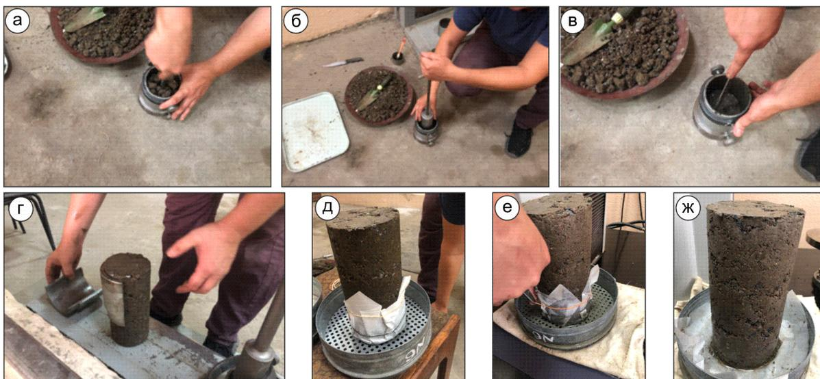
Рисунок 2 – Подготовка образца к испытанию: а – подача грунтощебеночного материала в цилиндрическую форму; б – трамбовка материала; в – устройство насечек на уплотненной поверхности; г – разбор цилиндрических форм; д – образец с фильтровальной бумагой, подготовленный для насыщения водой; е – освобождение образца от бумаги; ж – образец, подготовленный к испытанию
