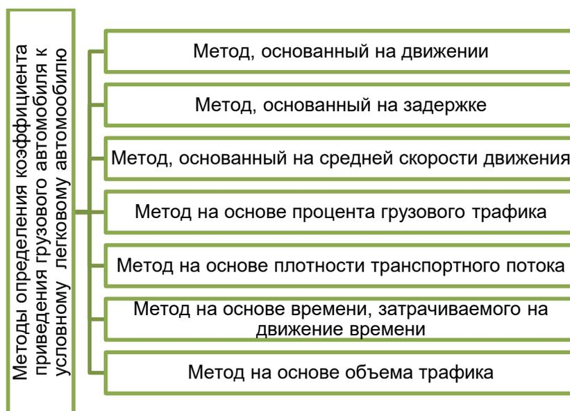
Рисунок 1 – Методы определения коэффициента приведения грузового автомобиля к условному легковому автомобилю в общем транспортном потоке
