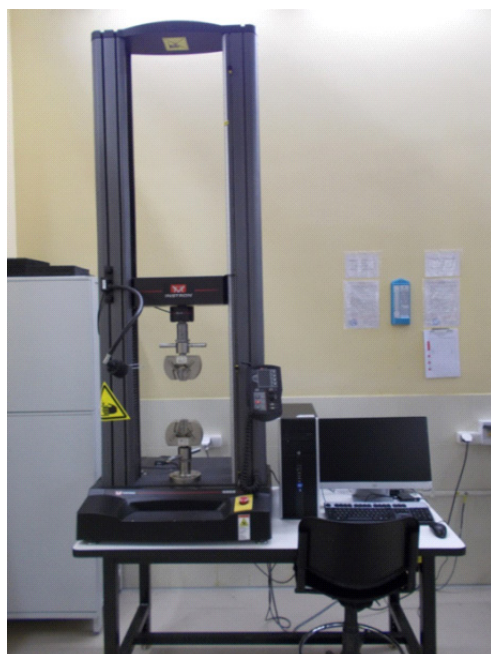
Рисунок 2 – Универсальная электромеханическая машина Instron 5969
