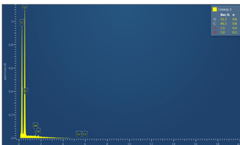
Рисунок 2 – Элементный состав частиц скопа
