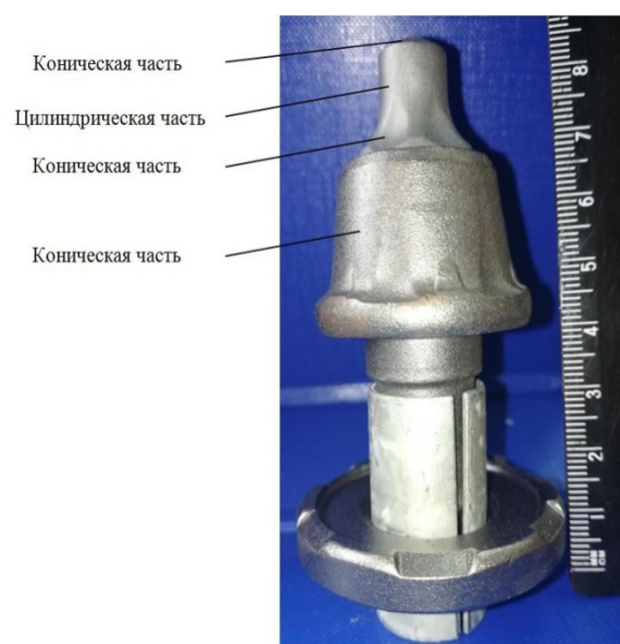
Рисунок 2 – Общий вид резца фрезерного рабочего оборудования экскаватора
