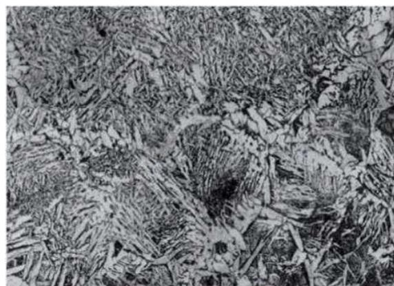
Рисунок 7 – Микроструктура зоны сплавления стыкового сварного соединения из стали Ст30МнВ5 толщиной 3 мм,  $\times 100$
