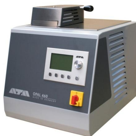
Рисунок 2 – Пресс для горячей запрессовки Opal 460
