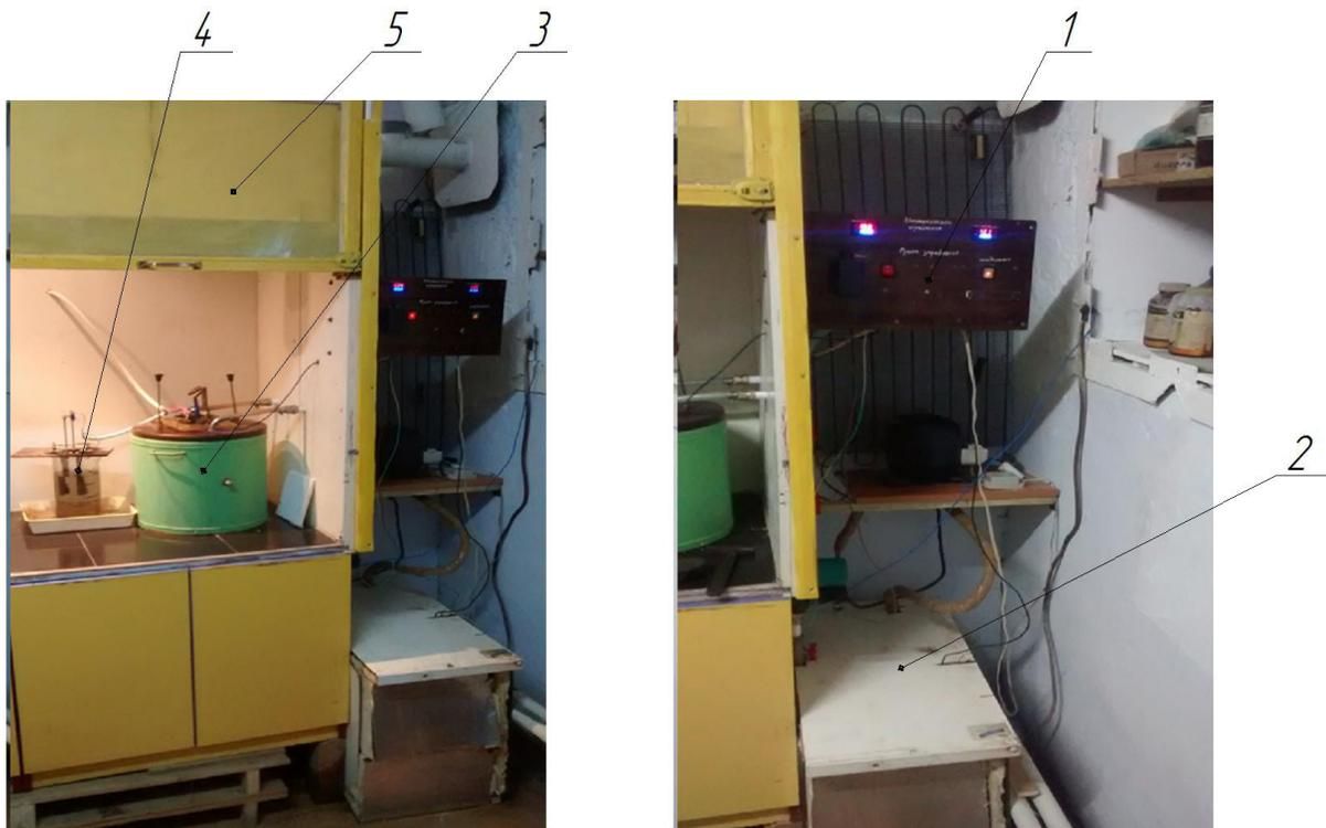
Рисунок 1 – Установка для исследований гальванических покрытий хрома [16]:
