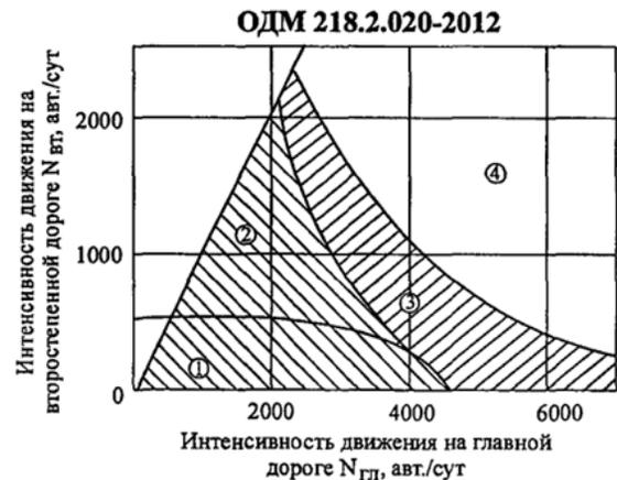
Рисунок 5 – Номограмма для определения пропускной способности пересечения
