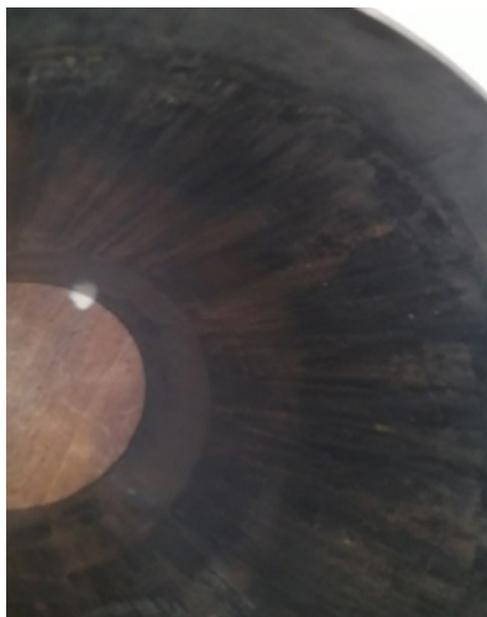
Рисунок 5 – Задирки на юбке поршня и внутренней полости гильзы
