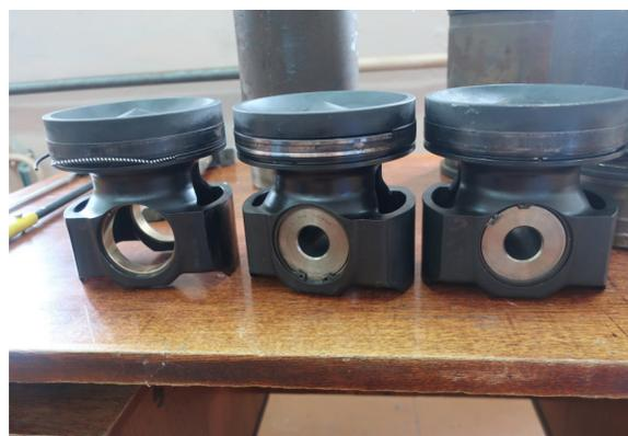
Рисунок 4 – Поршни дизель-генераторной установки Caterpillar 3512
