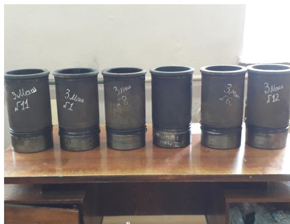
Рисунок 3 – Гильзы одного из ДВС дизель-генераторной установки Caterpillar 3512
