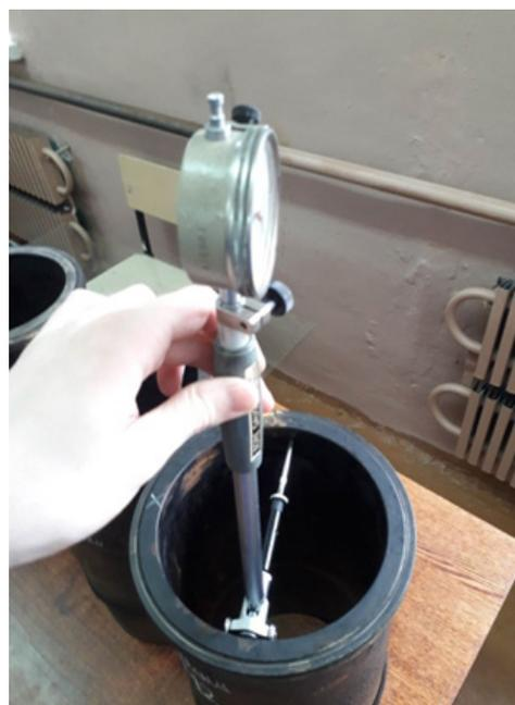
Рисунок 6 – Положение нутромера при замерах внутренних диаметров гильз цилиндров
