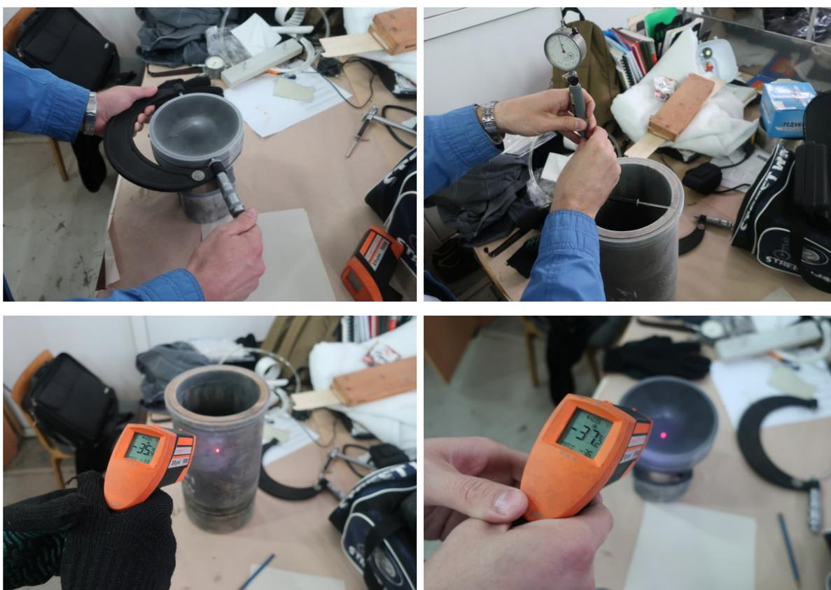
Рисунок 9 – Замеры охлажденных поршня и гильзы
