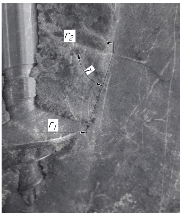
Рисунок 4 – Процесс отрыва грунта разрушающей частью винтовой лопастью винтового бура
