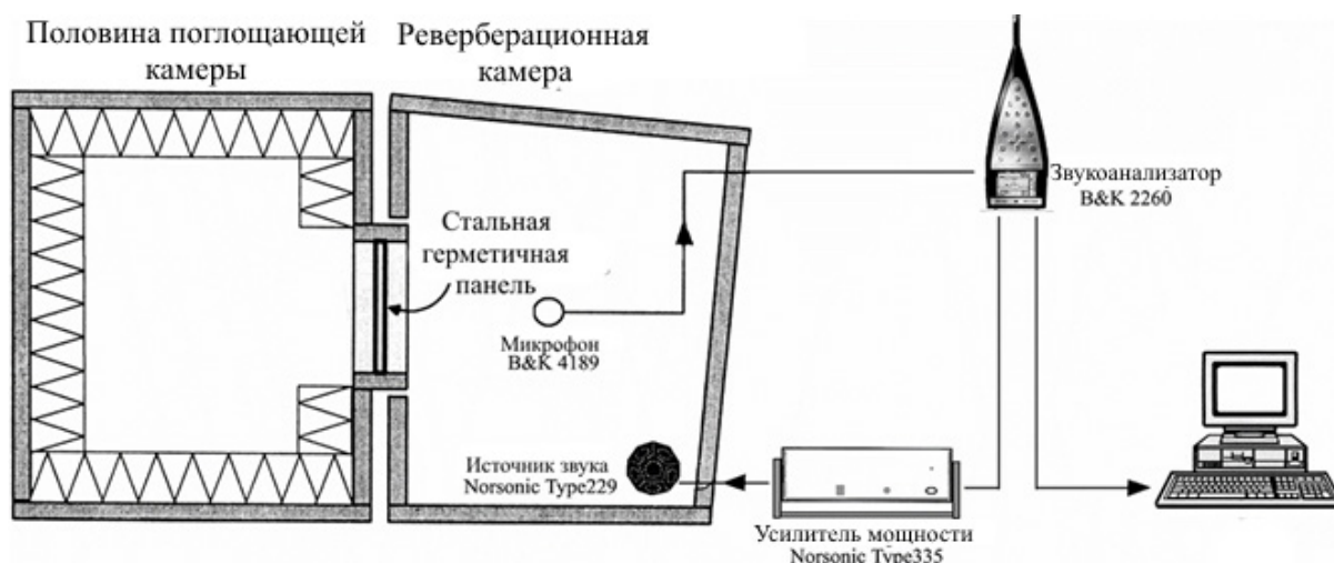
Рисунок 1 – Измерительная система реверберационной комнаты [17]
