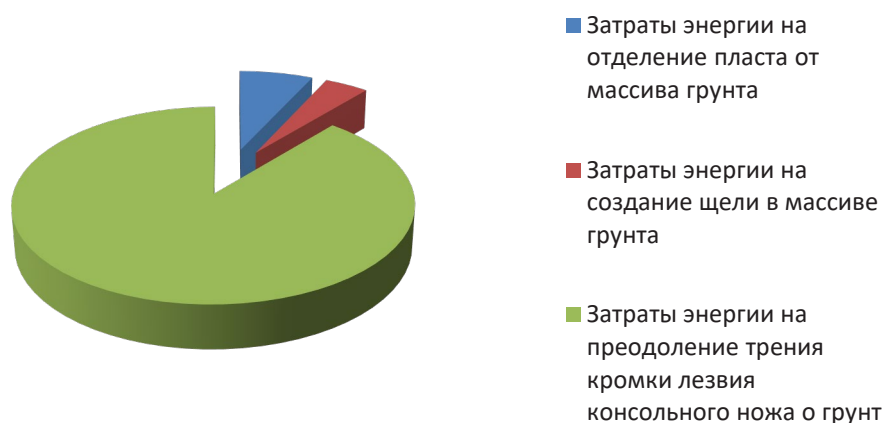
Рисунок 4 – Структура затрат энергии при взаимодействии кромки лезвия консольного ножа с грунтом при разработке грунта объёмом один кубический метр: затраты энергии на отделение пласта от массива грунта 7%, на создание щели в массиве грунта 4%, на преодоление трения кромки лезвия о грунт 89%
