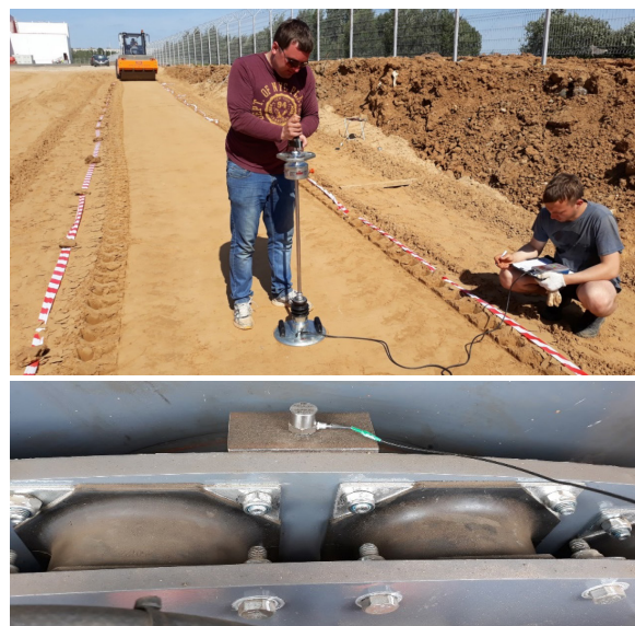
Рисунок 1 – Участок проведения экспериментальных исследований и место установки акселерометра на вальце катка DM-617
