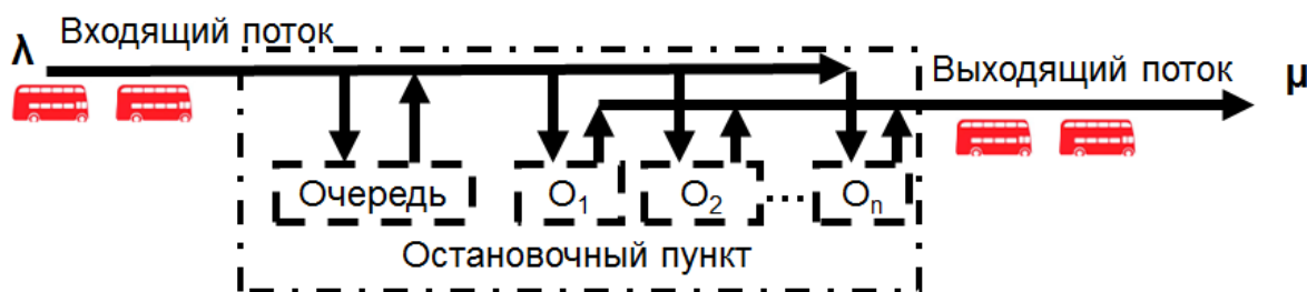
Рисунок 1 – Схема остановочного пункта как СМО O_1, \dots, O_n – каналы обслуживания
