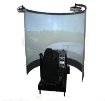
*в – имитация визуальной информации с помощью панорамного монитора, угол обзора 150–180°<sup>13</sup>
