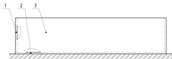
Рисунок 2 – Дно и короб станда: 1 – торцевая стенка короба; 2 – дно; 3 – боковая стенка короба
