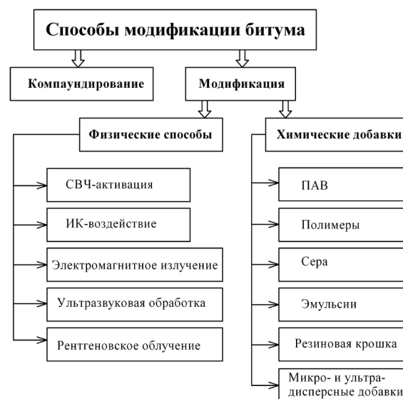
Рисунок 1 – Основные способы модификации битумов Figure 1 – Main methods of bitumen modification
