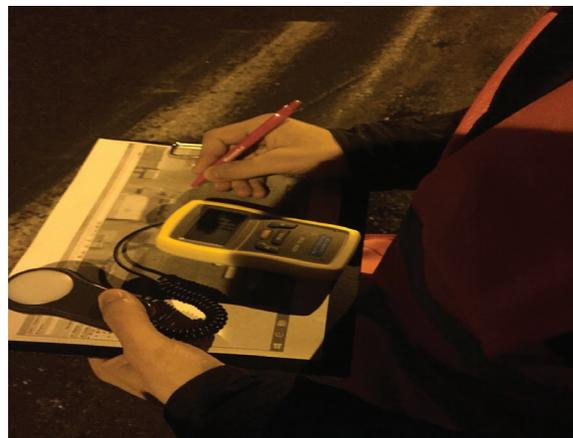
Рисунок 1 – Проведение измерения освещенности с помощью люксметра «Victor 1010A»
