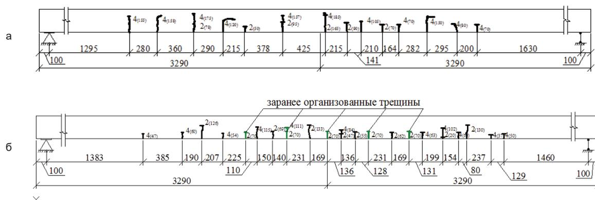
Рисунок 5 – Схема трещинообразования на четвертой ступени нагружения:
