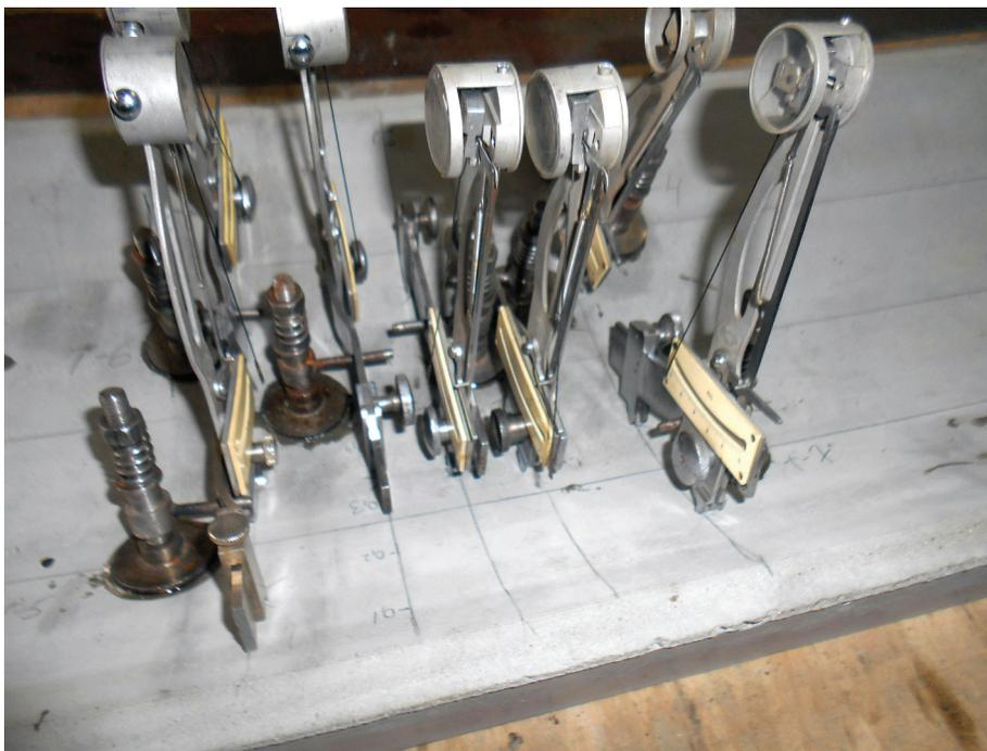
Рисунок 7 – Крепление рычажных тензометров к нижней поверхности полки модели плиты-оболочки: а – схема; б – фото
