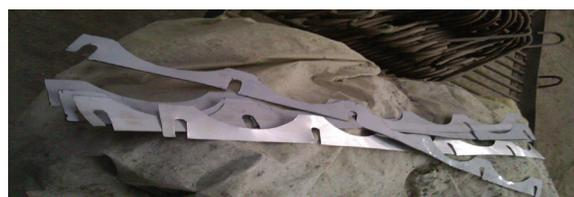
Рисунок 1 – Алюминиевые пластины для создания организованных трещин
