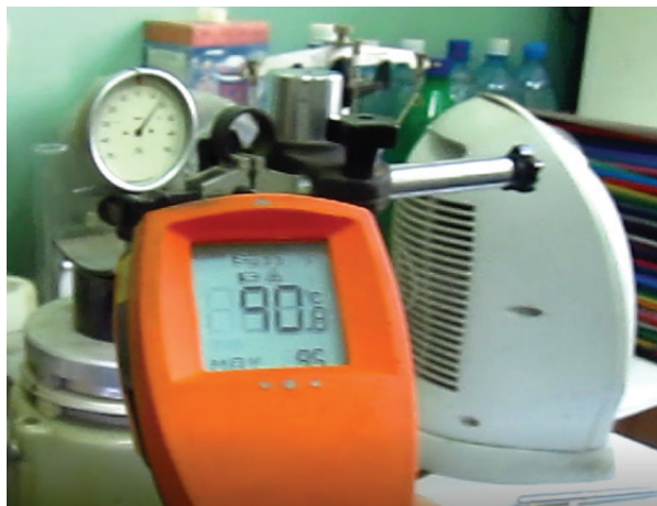
Рисунок 3 – Фрагмент измерения температуры подшипника скольжения
