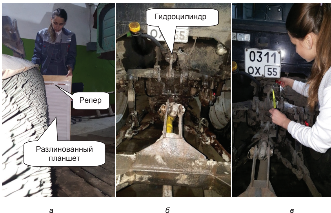
Рисунок 3 – Экспериментальная площадка: а – регистрация данных перемещения щеточного рабочего органа на фоне планшета; б – расположение гидроцилиндра привода рабочего оборудования; в – измерение перемещения штока гидроцилиндра
