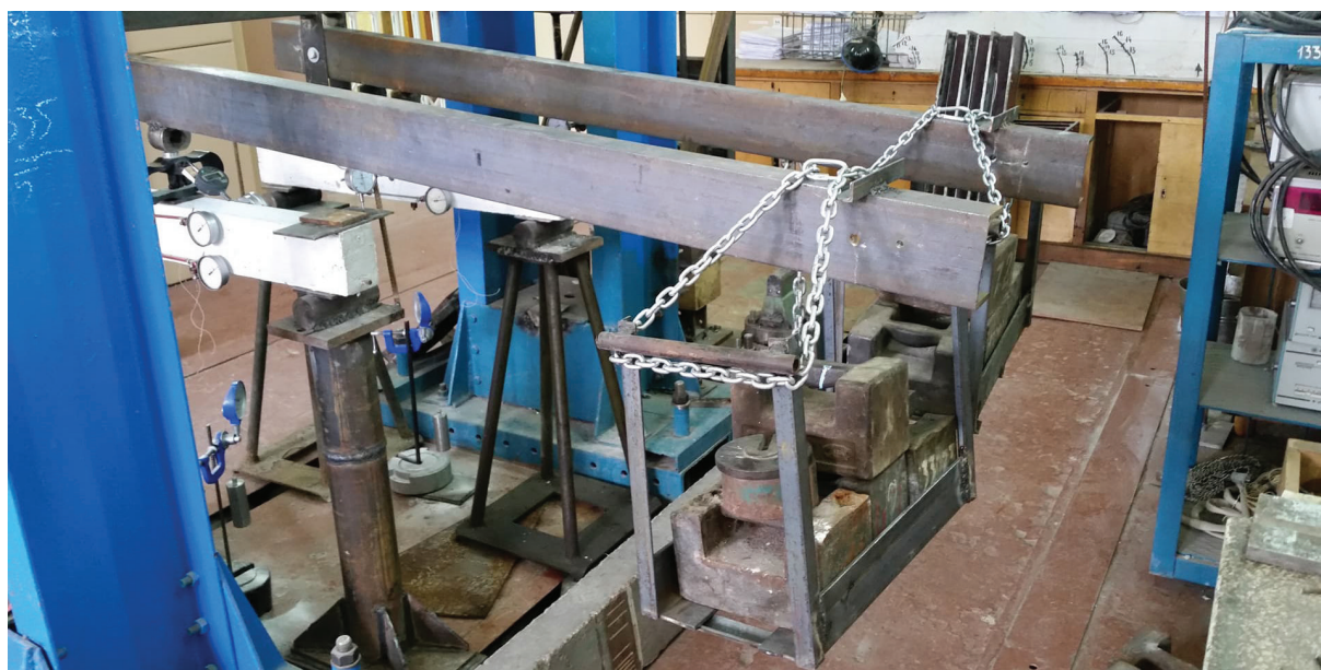
Рисунок 4 – Испытание железобетонных балок при воздействии длительных нагрузок
