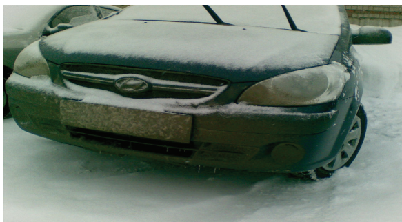
Рисунок – Внешний вид автомобиля с загрязненными внешними световыми приборами Figure – Appearance of the car with foul external light devices
