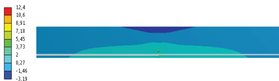
Рисунок 17 – Нормальные напряжения \sigma_x , МПа Illustration 17 – Normal stresses \sigma_x , Мр
