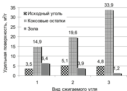
Рисунок 2 – Действительная удельная поверхность (по десорбции аргона): 1 – Экибастузский; 2 – Канско-Ачинский; 3 – Кузнецкий Illustration 2 – The actual specific surface area (by desorption of argon): 1 – Ekibastuz; 2 – Kansk-Achinsk; 3 – Kuznetsky
