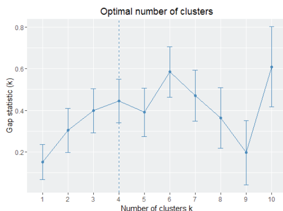
Рисунок 2 – Диаграмма определения оптимального числа кластеров на основе статистики Gap: по вертикальной оси – статистика Gap (оценка качества кластеризации для выбранного количества кластеров); по горизонтальной оси – количество кластеров Illustration 2 – The diagram of the optimal number determining of the clusters based on the Gap statistics: on the vertical axis – statistics Gap (evaluation of the clustering quality for the selected number of clusters); on the horizontal axis – the number of clusters
