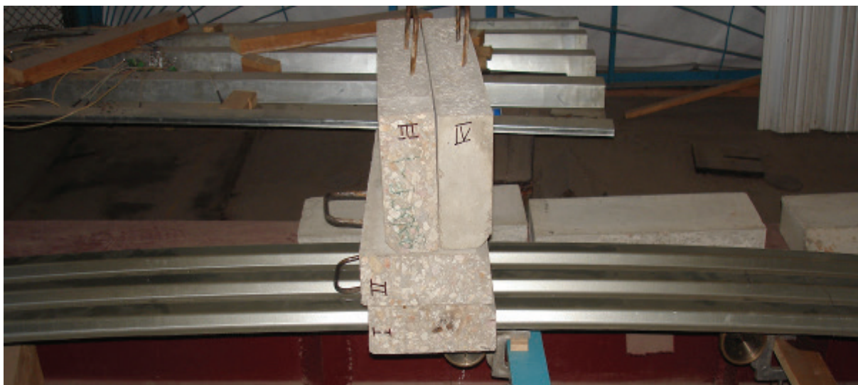
Рисунок 4 – Испытание профилированного настила на нагрузку от веса монтажника и оборудования в середине пролета
