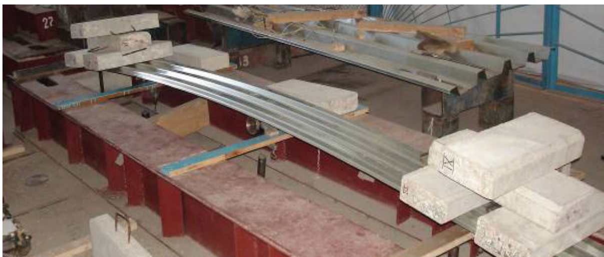
Рисунок 5 – Испытание профилированного настила на нагрузку от веса свежесушеного бетона в опорных зонах
