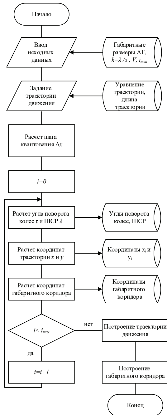
Рисунок 5 – Блок-схема алгоритма движения автогрейдера по заданной траектории
