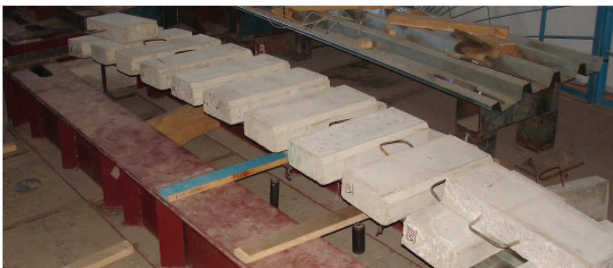
Рисунок 6 – Испытание профилированного настила на нагрузку от веса свежесушеного бетона распределенного по всей поверхности
