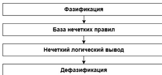
Рисунок 1 – Типовой механизм реализации управления на основе нечеткой логики Источник: составлено автором на основе данных работы [29].
