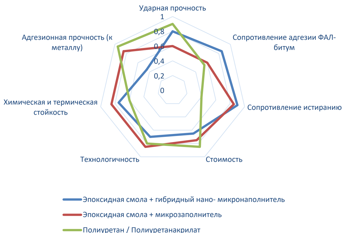
Рисунок 2 – Многокритериальный радиальный анализ систем покрытий для смесительных камер CIR Источник: составлено авторами.
