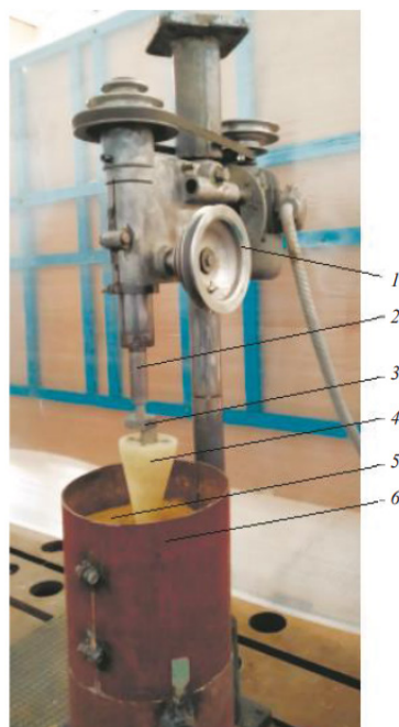
Рисунок 2 – Экспериментальный стенд: 1 – механизм подачи; 2 – привод; 3 – коленчатый вал; 4 – конусный раскатчик; 5 – уплотняемый грунт; 6 – разборная форма [23] Источник: составлено авторами.
