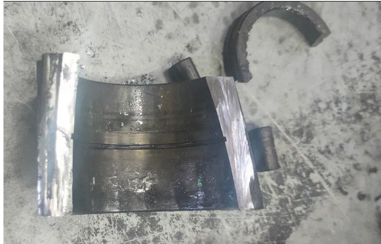
Рисунок 1 – Разрез шестерни: выкрашивание (питтинг) на внутренней беговой дорожке, выполняющее роль внешнего кольца подшипника Источник: авторские фотографии, сделанные в рамках научно-исследовательской работы по диагностике тяговых электроприводов.
