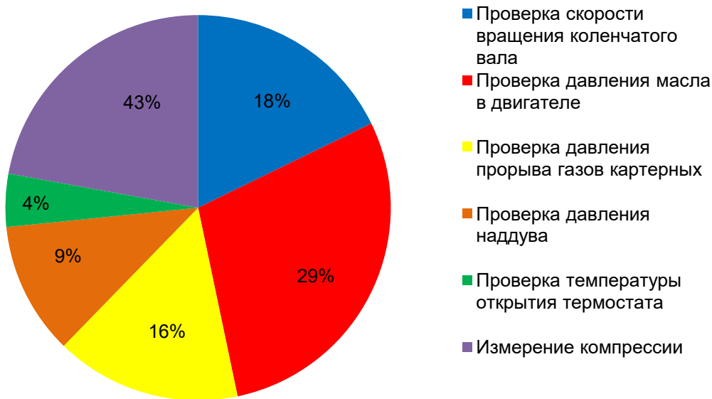
Рисунок 2 – Трудоемкость, затрачиваемая на диагностические операции двигателя силовой установки при проведении ТО-3 бульдозера марки Коматцу Д-355А Источник: составлено авторами.
