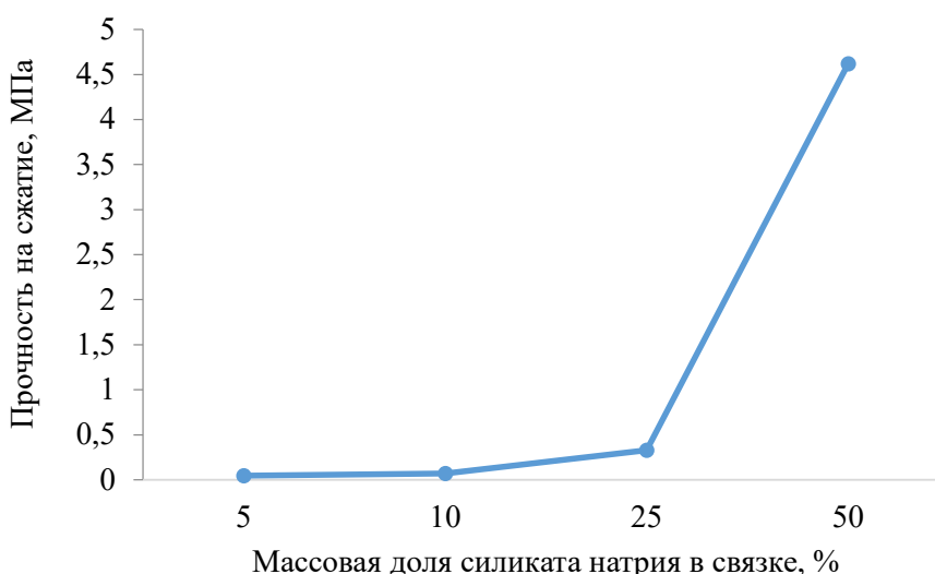
Рисунок 4 – Зависимость прочности сухих образцов от концентрации силиката натрия в связке Источник: составлено авторами.
