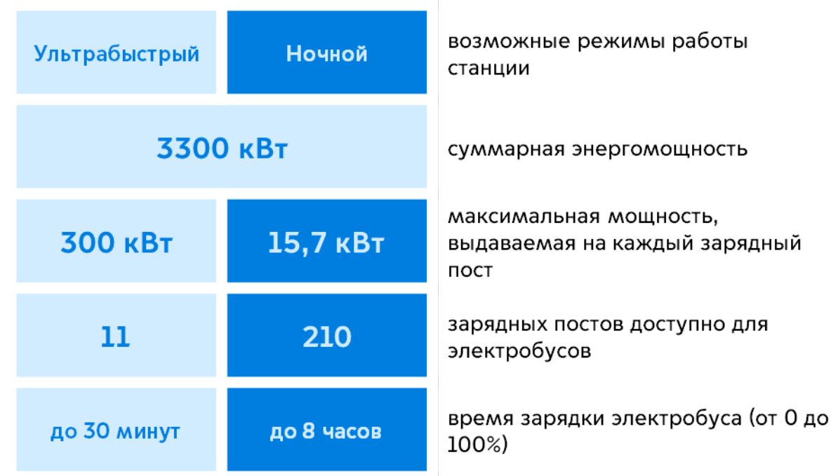
Рисунок 12 – Пример установки зарядной инфраструктуры для электробусов в Москве Источник: составлено авторами.
