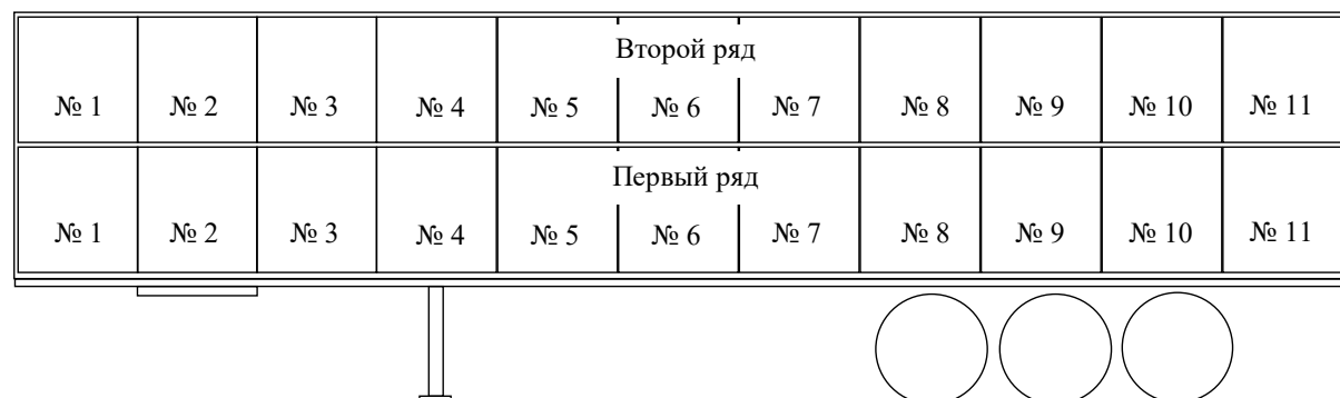
Рисунок 4 – Расположение грузовых мест в полуприцепе-птицевозе ТОНАР-98882 для размещения транспортировочных контейнеров Источник: составлено авторами.
