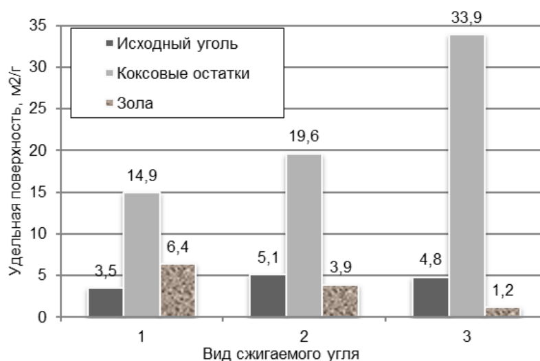
Рисунок 3 – Действительная удельная поверхность частиц (по методу БЭТ): 1 – экибастузский уголь; 2 – канско-ачинский; 3 – кузнецкий Источник: составлено автором.
