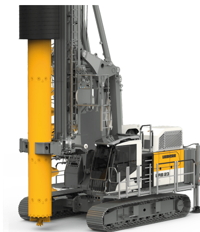
Рисунок 5 – Буровая установка для устройства свай Double Rotary Liebherr LRB23 8
