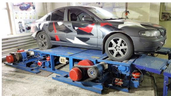
Рисунок 5 – Внешний вид КТС Volvo S60 2.5T AWD, установленного на полноопорный стенд с беговыми барабанами ИРННТУ Источник: составлено авторами.
