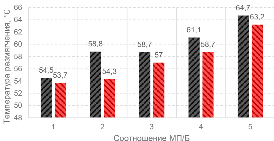
Рисунок 5 – Влияние вида и концентрации МП на температуру размягчения битума Источник: составлено авторами.
