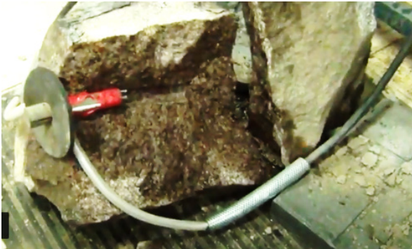
Рисунок 2 – Результат разрушения гранитного валуна шпуровой электрогидравлической установкой [1]
