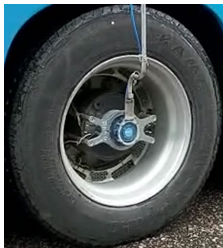
Рисунок 4 – Тензометрические измерительные колёса Kistler RoaDyn Источник: составлено автором.
