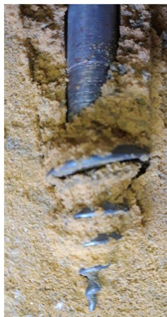
Рисунок 3 – Процесс разрушения грунта буровым инструментом
