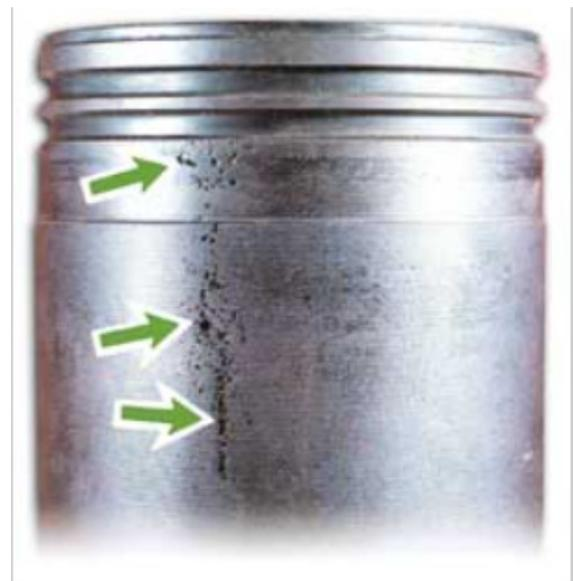
Рисунок 1 – Кавитационная эрозия стенки цилиндра [14]
