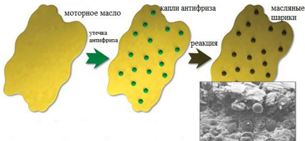
Рисунок 2 – Механизм образования масляных шариков из-за загрязнения картерного масла гликолем [14]
