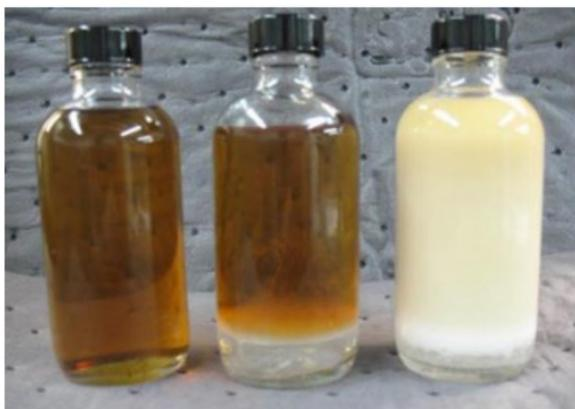
Рисунок 3 – Вода в моторном масле в различных состояниях [17]
