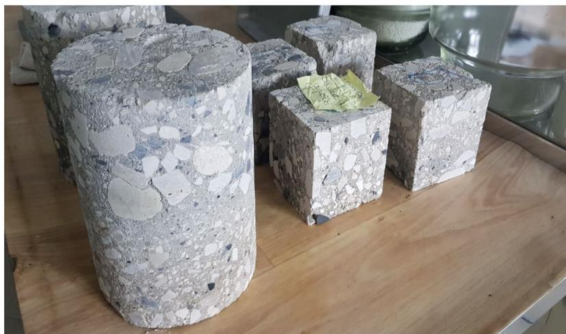
Рисунок 2 – Керны и кубы разработанного материала, подготовленные для испытания
