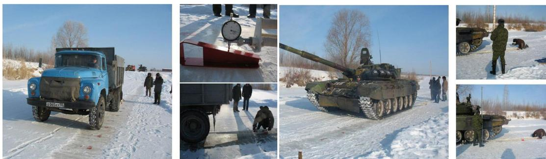
Рисунок 5 – Испытание опытного участка на полигоне колесной и гусеничной техникой
