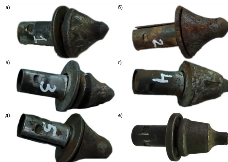
Рисунок 2 – Режущие элементы с разной степенью износа: а – режущий элемент, изношенный на 17,87%, б – режущий элемент, изношенный на 25,76%, в – режущий элемент, изношенный на 21,51%, г – режущий элемент, изношенный на 16,7%, д – режущий элемент, изношенный на 18,48%, е – новый режущий элемент Источник: составлено авторами.
