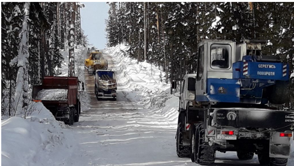
Рисунок 3 – Применение тракторной техники в качестве тягача для перемещения грузового автомобильного транспорта в суровых условиях Крайнего Севера (Республика Саха [Якутия]) Источник: составлено авторами.
