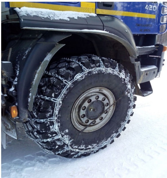
Рисунок 1 – Внешний вид колеса грузового автомобиля с цепью против скольжения для движения на участках дорог с подъемами и спусками в суровых условиях Крайнего Севера (Республика Саха [Якутия]) Источник: составлено авторами.
