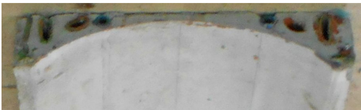
Рисунок 3– Вид железобетонной модели: а – чертеж поперечного сечения; б – фото торца Источник: составлено авторами.
