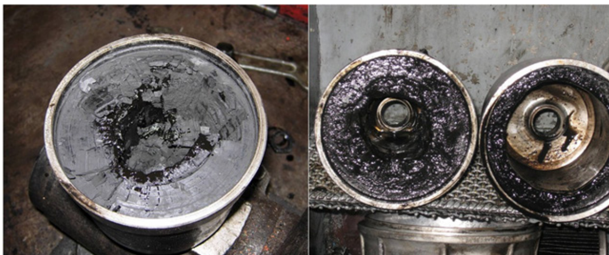
Рисунок 1 – Отложения на стенках ротора фильтра центробежной очистки Источник: составлено авторами.
