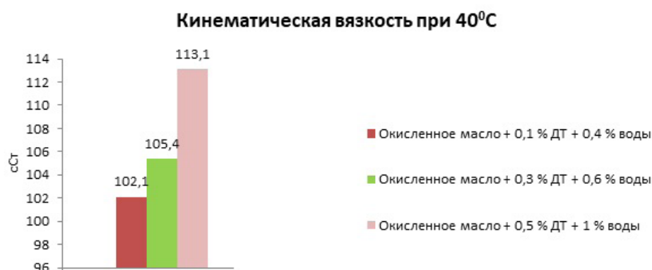
Рисунок 5 – Сравнительные значения кинематической вязкости окисленного моторного масла Gazpromneft Diesel Ultra 10W–40 с различными концентрациями дизельного топлива и воды Источник: составлено авторами.
