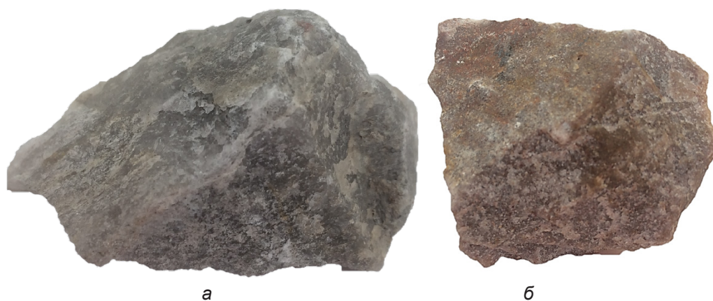
Рисунок 2 – Разновидности кварцитопесчаников: а – незатронутый процессами выветривания; б – выветренный Источник: составлено авторами.
