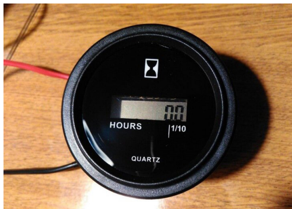
Рисунок 1 – Датчик измерения времени работы двигателя (мото-часов)
