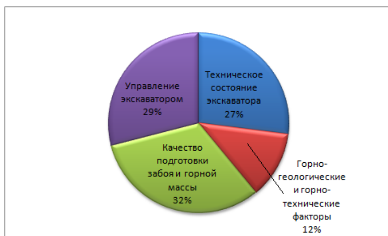
Рисунок 2 – Факторы, влияющие на работоспособность экскаватора
