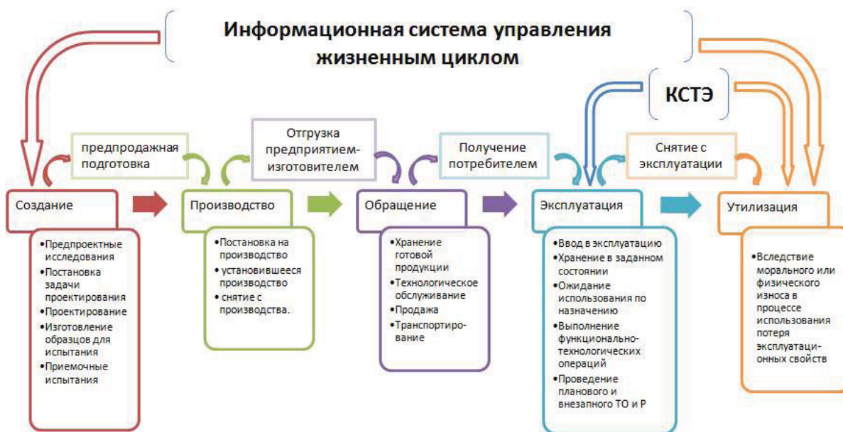
Рисунок 1 – Схема управления жизненным циклом дорожных машин: КСТЭ – комплексная система технической эксплуатации [2]
