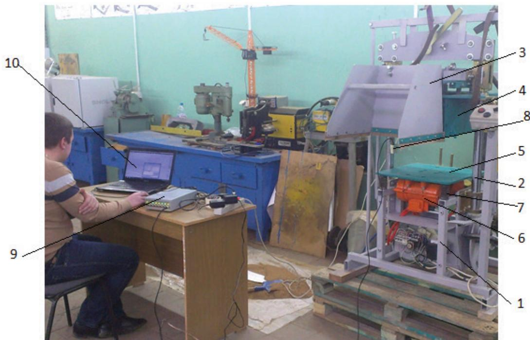
Рисунок 3 – Общий вид вибропресса ОПТВ-400 с установленной измерительной системой
