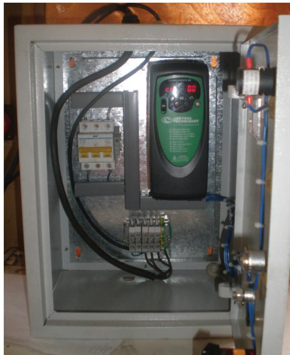
Рисунок 1 – Блок управления опытной виброплощадки
