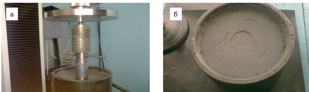
Рис. 1. Определение модуля деформации ЗШС: а – образец в нагружающем устройстве; б – след от штампа
