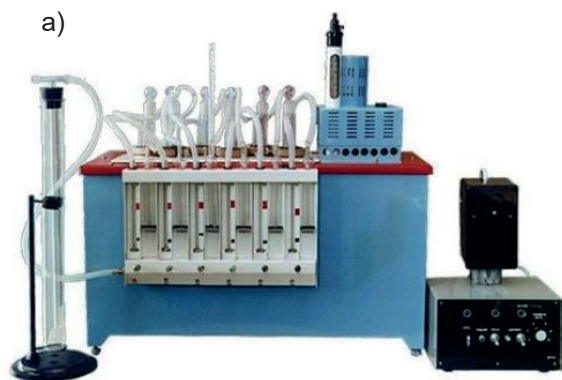
Рис.5. Аппарат для определения стабильности масел: а) общий вид; б) схема: 1 – термостатирующая баня; 2 – блок управления; 3 – блок ротаметров; 4 – моностаг; 5 – прибор ВТИ; 6 – приёмная ловушка; 7 – контрольный термометр; 8 – заглушка; 9 – щуп; 10 – штатив; 11 – электронный датчик температуры; 12 – кран; 13 – терморегулятор; 14 – розетка РШАГКУ-14-1; 15 – заводская табличка.
