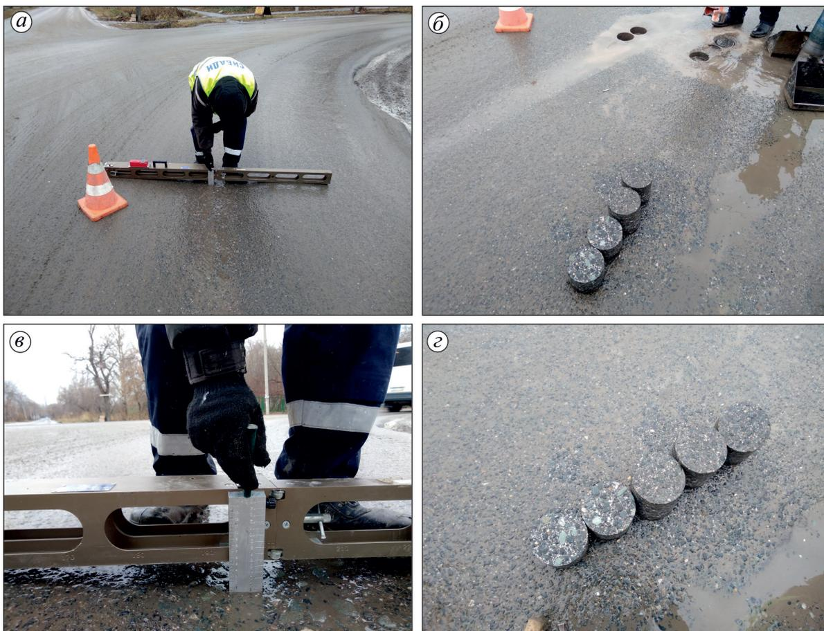
Рисунок 5 – Обследование колеи на дороге по ул. 1-я Чередовая в г. Омске:
