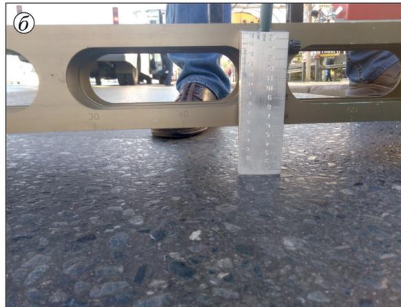
Рисунок 7 – Измерение глубины внешней и внутренней колеи на дороге по ул. Интернациональная:
