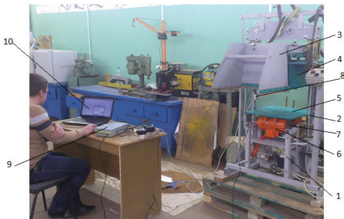
Рисунок 3 – Общий вид вибропресса ОПТБ-400 с установленной измерительной системой
