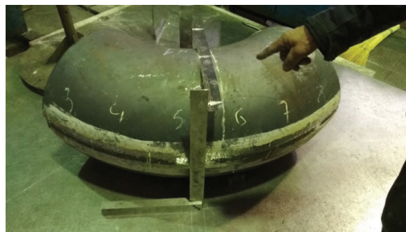
Рисунок 3 – Плазировка и разметка отвода крутозагнутого штампосварного в реальных производственных условиях
