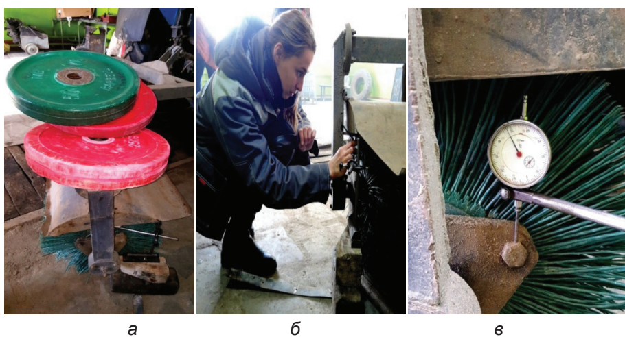
Рисунок 3 – Экспериментальная площадка а – щёточный рабочий орган, пригруженный тарированным грузом; б, в – измерение деформации щёточного ворса при помощи индикатора часового типа
