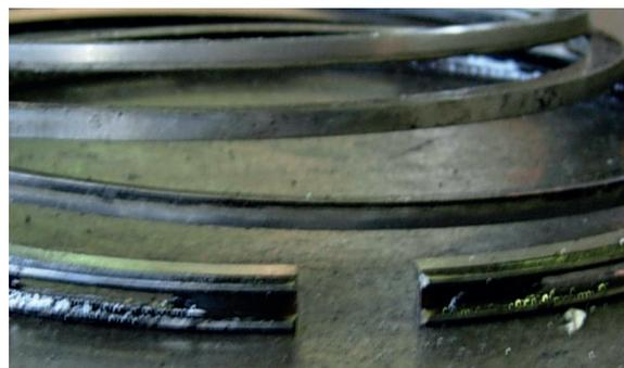
Рис. 3 Отложения на поверхностях цилиндра-поршневой группы
