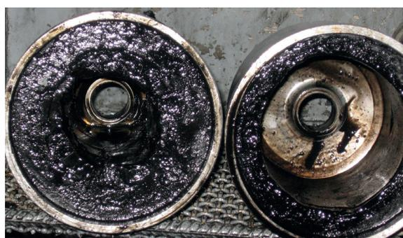
Рис. 4 Отложения на стенках центробежного фильтра очистки масла
