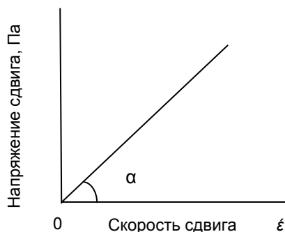
Рисунок 1 – График вязкого течения ньютоновской жидкости
