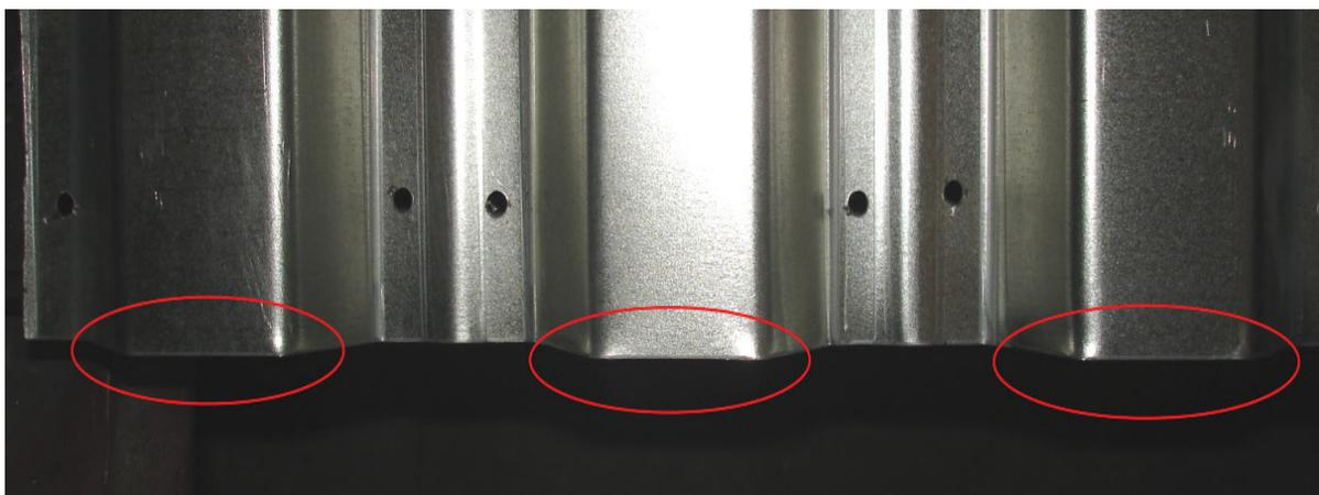
Рисунок 10 – Картина обмятия торцевых участков профилированного настила
