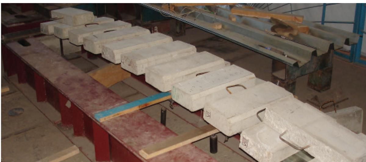
*Рисунок 6 – Испытание профилированного настила на нагрузку от веса свежесушеного бетона распределенного по всей поверхности*
