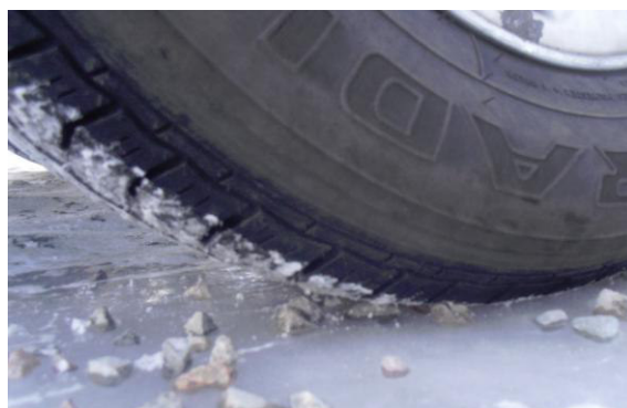
Рис. 2. Каменная шероховатость на ледяном слое дорожного покрытия
