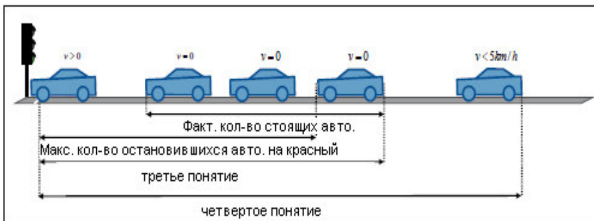
Рис. 2. Определение понятия длина очереди перед светофорным объектом
