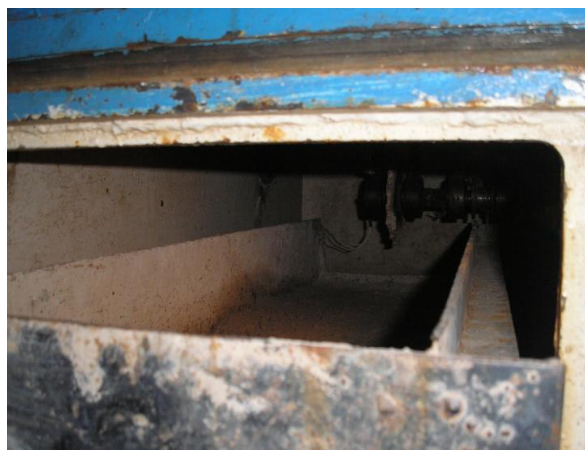
Рис. 4. Роторно-дисковый рабочий орган, установленный в герметичном корпусе
